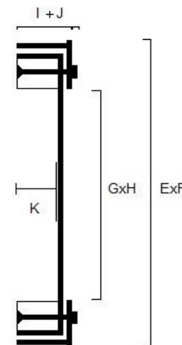
Junta de estanqueidad: Cordon EPDM CELULAR de 8mm.
