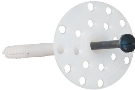
Tacos de fijación mecánica certificados ETAG 014, con un plato de 60 mm., para taladros (broca) de un diámetro de 10 mm. con cabeza circular. Están fabricados en plástico para evitar condensaciones que puedan provocar manchas en el revestimiento. Se utilizan para la fijación mecánica de las placas aislantes al soporte, debiendo garantizarse una profundidad de anclaje mínima de 50 mm. y un consumo aproximado de 8 ud/m<sup>2</sup>.
