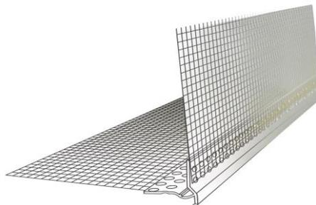
Perfil con goterón de PVC con malla de fibra de vidrio álcali-resistente y certificada ETAG 004, empleado en el enlucido final de los dinteles de puertas y ventanas con el fin de evitar escorrentías en los cambios de plano, impidiendo el retorno y filtración de agua al interior de la pared. Este perfil con resalto de goteo no se cubre con las capas de enlucido, lo que garantiza el drenaje del dintel.
