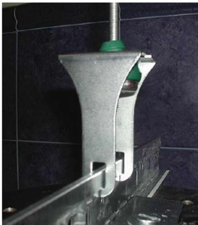
Muestra bajo carga de 50 kg
