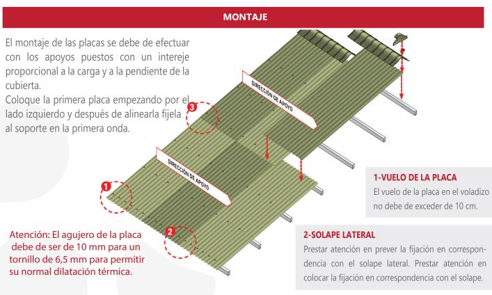
A continuación, realizar la segunda fijación en la viga superior. Solapar lateralmente la segunda placa sobre la primera y fijar. Para mantener la alineación de las placas y tornillos se recomienda utilizar un hilo sujeto a los extremos de la cubierta.
