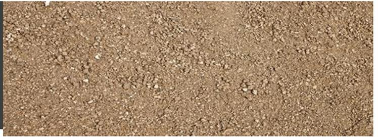
Árido grueso sometido a proceso de doble lavado y clasificación; con una composición básicamente silíceo y resultado de la combinación de diferentes arenas y piedras naturales.
