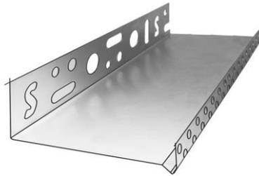
Perfil de arranque fabricado en aluminio de 0,7 mm. de espesor, se coloca horizontalmente en el límite inferior de la zona a revestir, anclado al soporte mediante tornillos, distanciadores y conectores, con un espacio de 3 mm. de separación entre ellos, facilitando el arranque del montaje del sistema y garantizando su horizontalidad. Incluye un goterón que garantiza el drenaje vertical del agua evitando su retorno.
