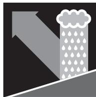
La cubierta debe tener una pendiente mínima de entre 15 y 17 °. Las distintas láminas deben solaparse entre 12-15cm, como mínimo, (zona perfectamente señalizada con una línea discontinua a lo largo de cada rollo). En cubiertas con una pendiente inferior a 22° es aconsejable solapar 20 cm, como mínimo, y sellar la unión con cinta adhesiva.
