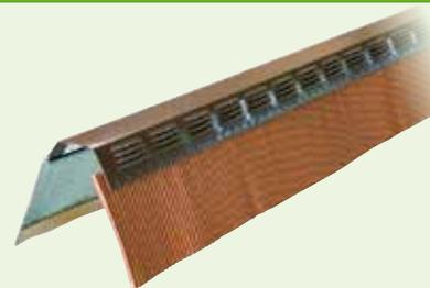
El bajo cunbrera ventilado está realizado con casco en lámina de aluminio o cobre de 6/10, una serie de aberturas a celosías horizontales sobre ambos lados garantizan una perfecta ventilación. El casco se completa con bisagras plisadas de aluminio o cobre con remate adhesivo de cola butílica. El desarrollo amplio del plisado garantiza una fácil colocación y seguridad contra las filtraciones de los agentes atmosféricos.
